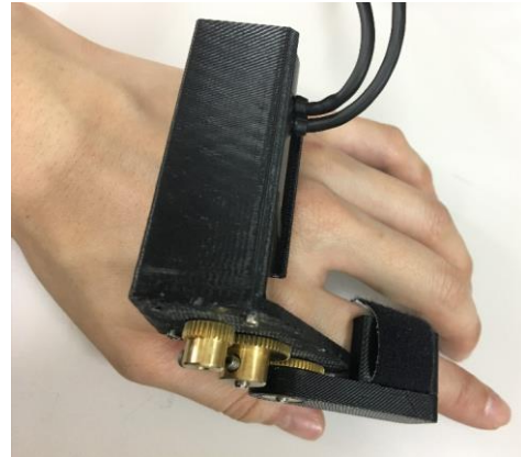
図4(b) : 振戦抑制支援機器の試作機
