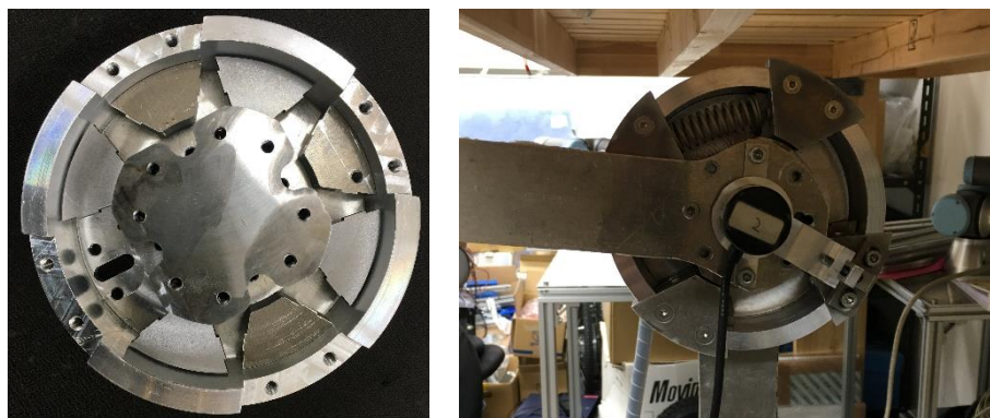
(a) ばね挿入のための関節構造 (b) ロボットアームへの組み込み
